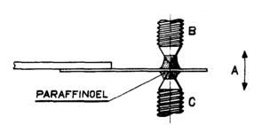
Oberfläche bleibt metallisch glänzend. Die durch die Löschfunken losgerissenen, kleinsten Metallpartikelchen werden beim Schliessen der Kontakte durch die Flügsigkeitsbewegung ausserhalb der Kontaktstelle getragen. Dort lagern sie sich ab und können deshalb den Kontaktschluss nicht beeinträchtigen. Das Paraffinöl ist sehr beständig. Die einwandfreie Funktion des Instrumentes ist daher auf lange Dauer gewährleistes. "
